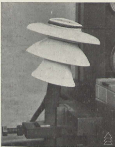
Fig. 3. Zugversuch an einem Weitschirm-Isolator (W. 60),
