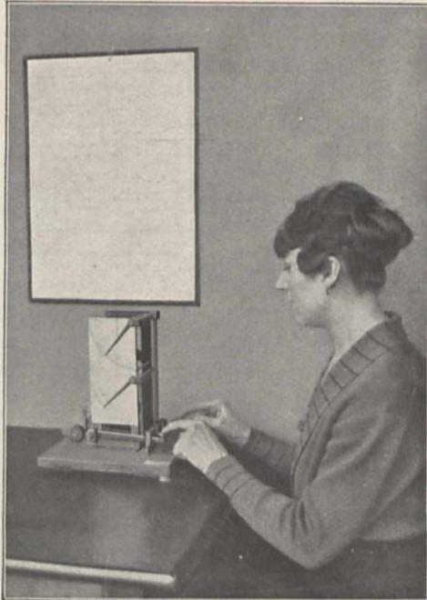
Fig. 1. Der Tastendruckprüfer
