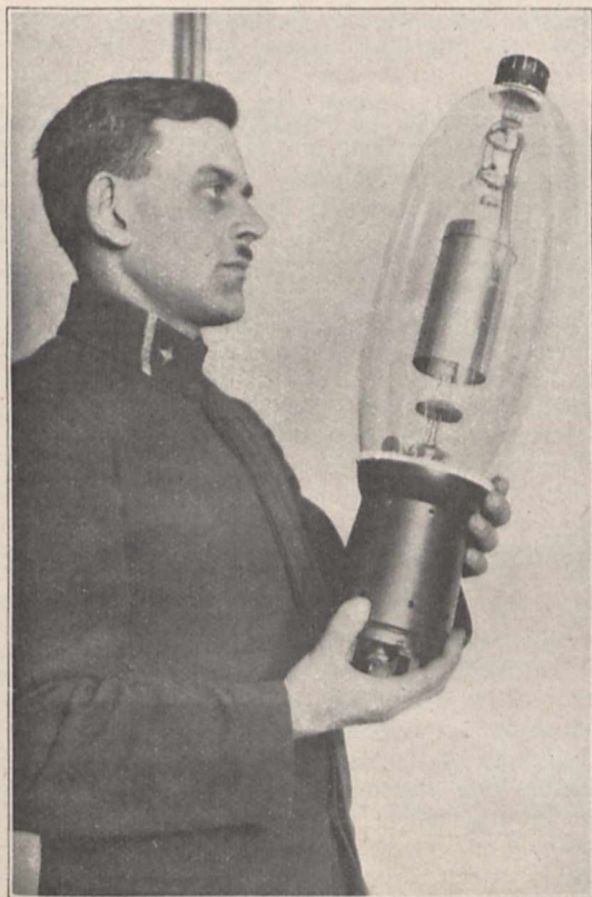
Eine der großen Senderöhren mit denen die „Deutsche Stunde“ ihre Radio-Berichte und Unterhaltungen verbreitet.
