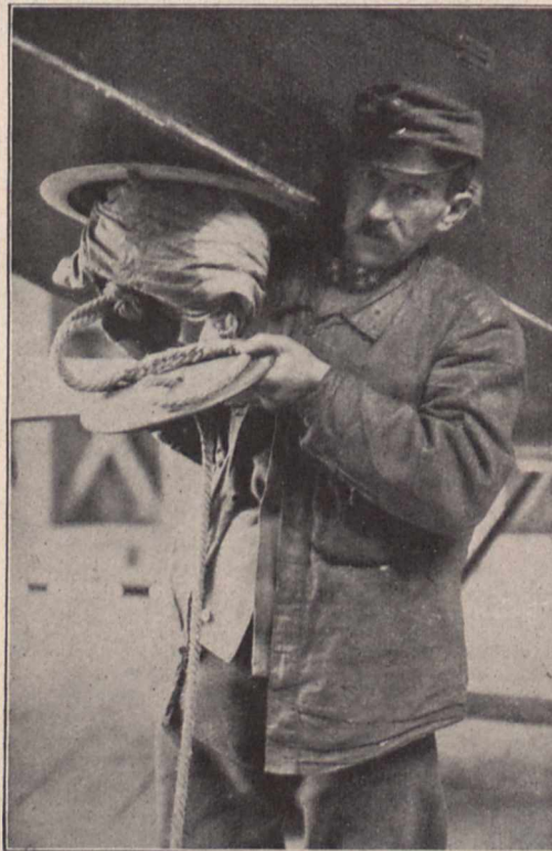
Fig. 9. Tubus-Fallschirm im Flugzeugrumpf hinter dem Gaststz untergebracht.
