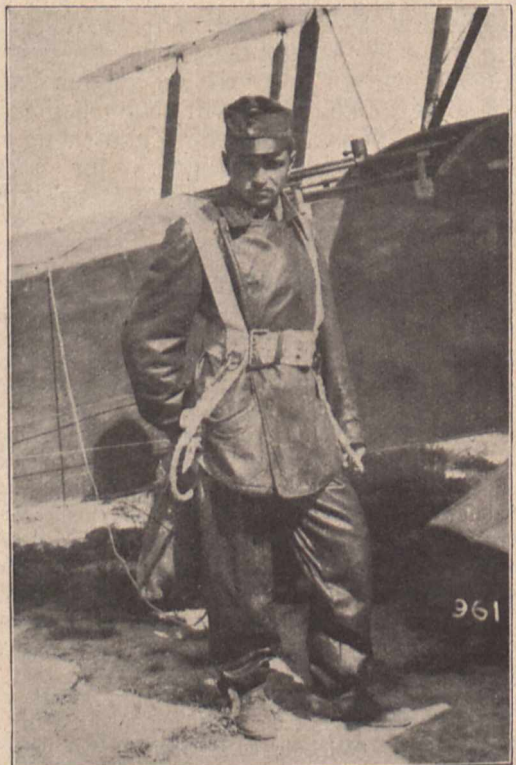
Fig. 5. Heinecke-Fallschirm gebrauchsfertig. Es besteht Seilverbindung mit dem Flugzeug.
