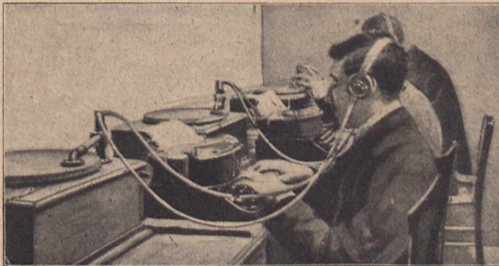
Fig. 2. Von einem Phonographen mit langsamerem Gang als dem Aufnahme-Phonographen werden die Telegramme durch Funker abgehört und mit geräuschloser Schreibmaschine niedergeschrieben.
