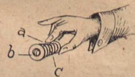
durch ab, daß er die Manschette an der Verschlussstelle spreizt und den Knopfverschluss gespannt hält. Der Halter besteht aus zwei Ringen a, b, welche
