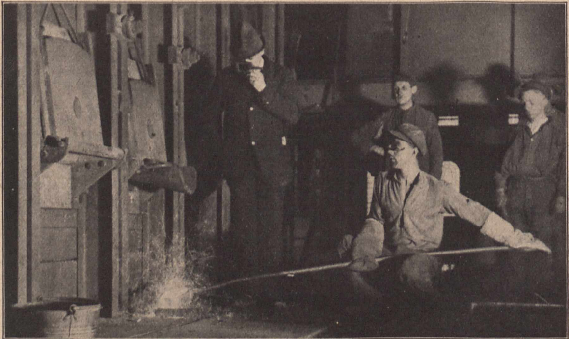
Fig. 1. Probeentnahme des flüssigen Bosshardt-Stahles vor dem Abstich.
