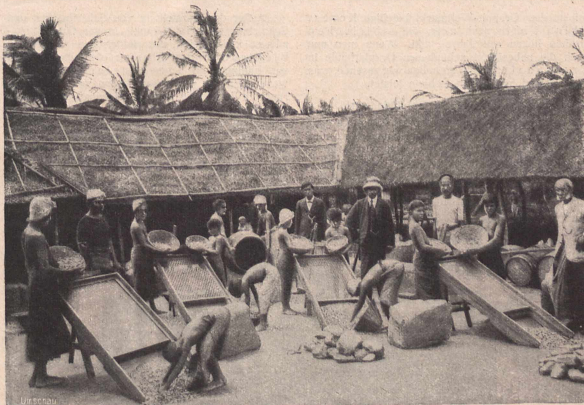
Fig. 2. Die Unreinigkeiten werden mittels grosser Wurfsiebe aus dem Graphit ausgesiebt.
