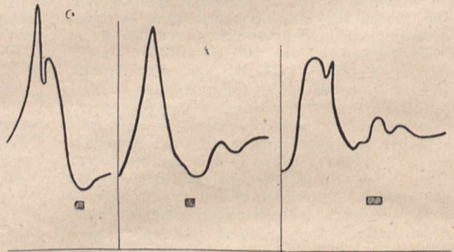
Fig. 6. Radioaktivitätskurve über einem Eisenerzgang.
