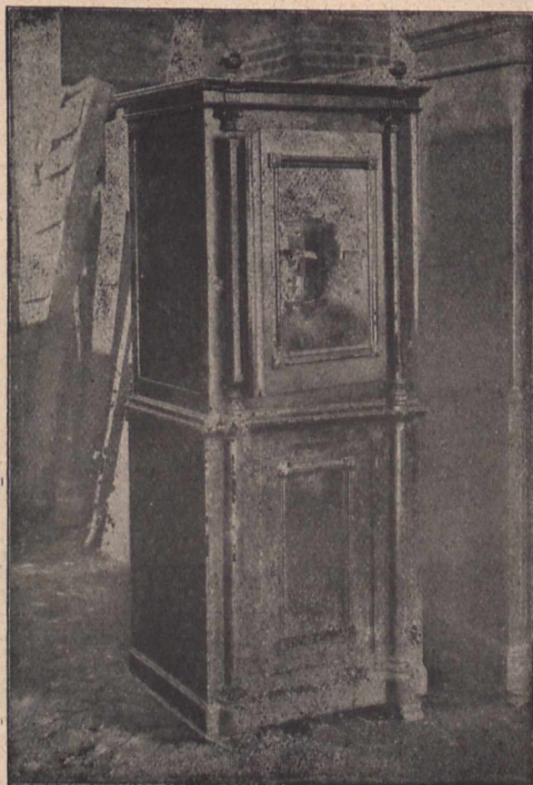
Fig. 3. Aelterer Geldschrank mittels „Knabbers“ in 7 Minuten völlig geräuschlos erbrochen.
