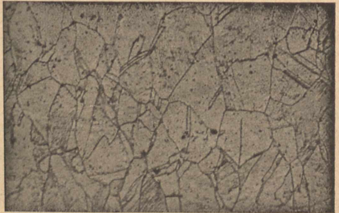
Fig. 1. Der Querschnitt zeigt das Gefüge eines Stahles nach Ablöschchen bei 1200° in Öl. (Stark vergrößert.)
