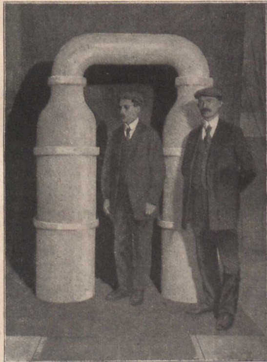
Fig. 9. Destillationsgefäß für Schwefelsäure aus Quarz (Ersatz für Platin).
