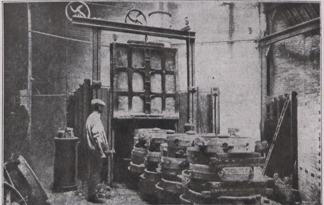
Bild 2. Das Trocknen der Sandformen.
