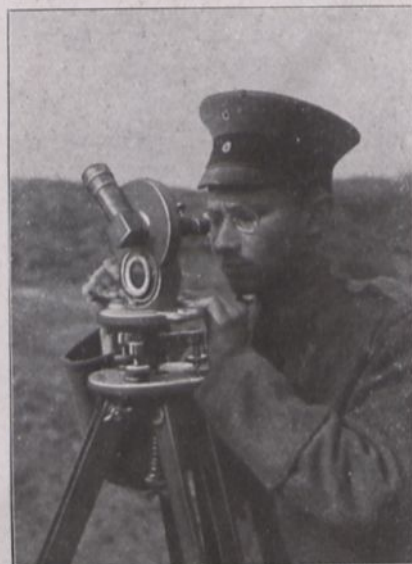
Bild 12. Theodolit zur Beobachtung in großen Höhen.
