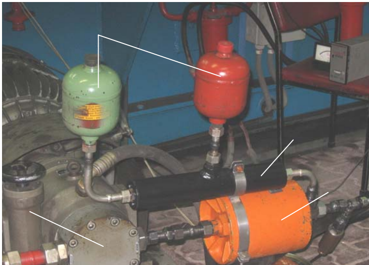
Rys. 8.19. Widok zamontowanego tłumika szerokopasmowego w układzie badawczym, 1 – tłumik czynny, 2 – tłumik komorowy, 3 – pompa wielotłoczkowa typ PNZ-100, 4 – akumulatory hydropneumatyczne.
