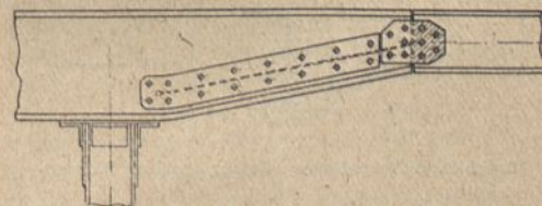
Anschluß eines niedrigen an einen hohen I-Träger durch Aufspalten und Zusammenbiegen des letzteren.
