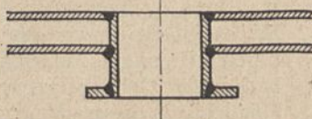
Autogene Schweißung rechtwinklig zusammenstoßender Teile.
