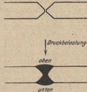
Autogene Stumpfschweißung mit beiderseitig keilförmiger Schweißnaht.
