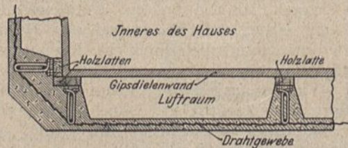
Außenwanddecke eines Wohngebäudes aus gespritztem Eisenbeton.
