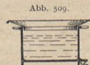
Elektrisch beheizter Schmelzkessel für Temperaturen bis 200° C.
