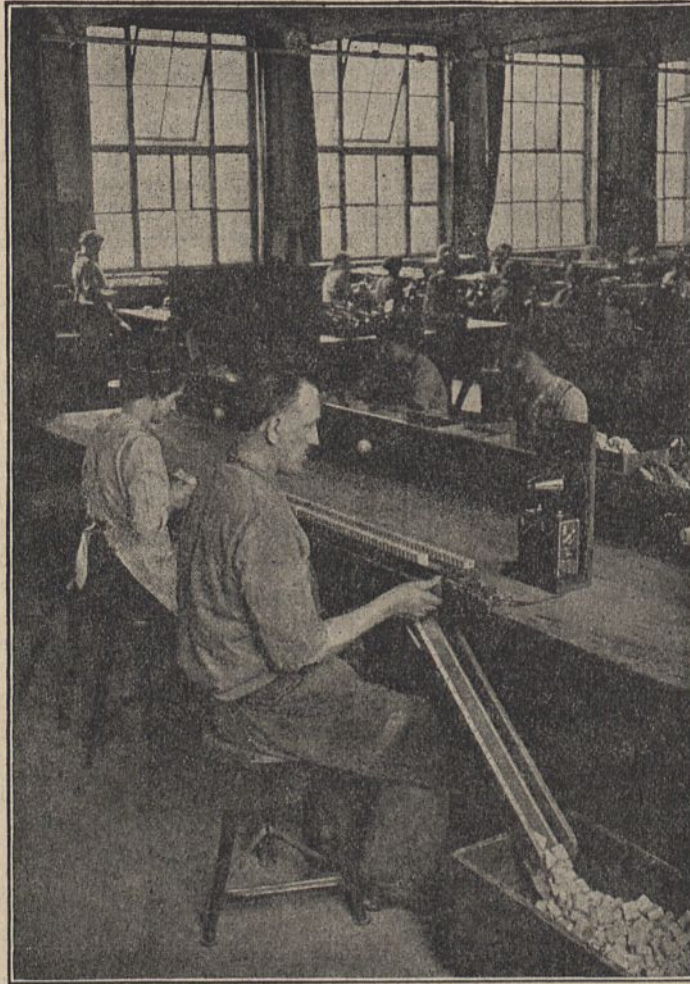
1) Akustische Prüfung von Schmelzstößeln.
