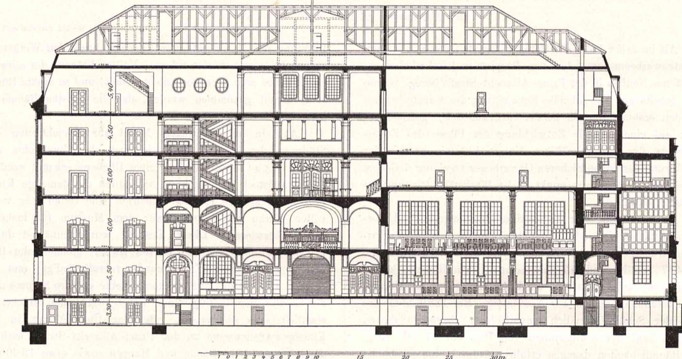
Abb. 1. Schnitt durch den Nordflügel parallel zur Straße.
