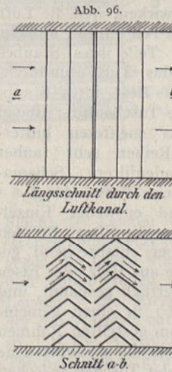
Schema eines Streifenfilters (Zickzackfilters).
