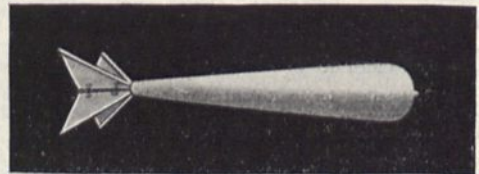
Kegelförmiger Versuchskörper mit Gleichgewichtseinrichtung am hinteren Ende. Er läßt sich nur bei geringen Geschwindigkeiten auf solche Weise stabilisieren.
