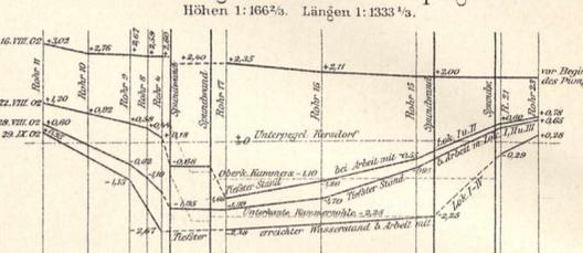
Abb. 2 u. 3. Senkung des Grundwasserspiegels 1902. Höhen 1:166%, Längen 1:1333 1/3.
