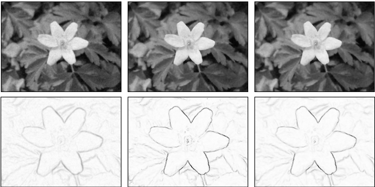
Rysunek 2-26: Wynik działania filtrów: liniowego \sigma=0.8 (iteracja 180), PM g_1 adaptacyjny (iteracja 5), PM g_2 adaptacyjny (iteracja 5); dolny rząd – detekcja krawędzi.
