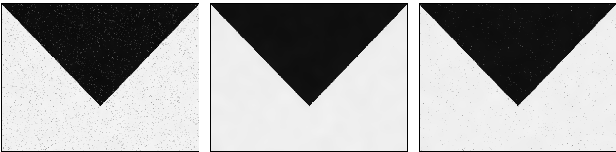
Rysunek 2-14: Wyniki filtracji dla 150 iteracji z parametrem K=20, 50 oraz dla wersji adaptacyjnej, funkcja g_I . Początkowe zaszumienie obrazu \sigma_n = 40 .
