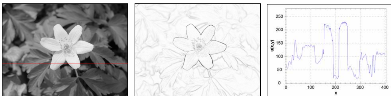
Rysunek 2-5: Obraz testowy nr 1 (rozmiar 400x300), detekcja krawędzi, przebieg funkcji jednej linii obrazu ( y=105 , linia zaznaczona kolorem czerwonym).
