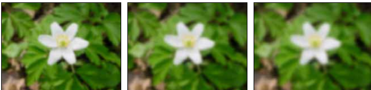
Rysunek 2-3: Wynik działania filtracji uśredniającej, rozmiar okna 3 \times 3 (odpowiednio 50, 100, 150 iteracji).
