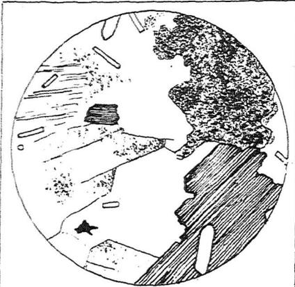
Abb. 85. Dünnschliff durch den Granit von Strehla. Links getrüübter Orthoklas, mitten klarer Quarz, rechts zwei Biotitblättchen. Im Feldspat schmale Apatitleisten im Längsschnitt, im Glimmer ein Zirkon. 20 f. vergr. (Orig. d. Verf.)
