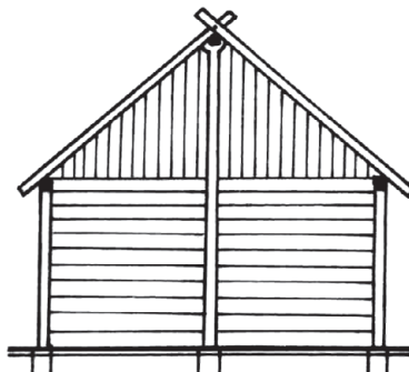
Ryc. 37. Wiązanie na sochach pojedynczych (oprac. na podstawie [Encyklopedia... 1873], t. 1, s. 243)
