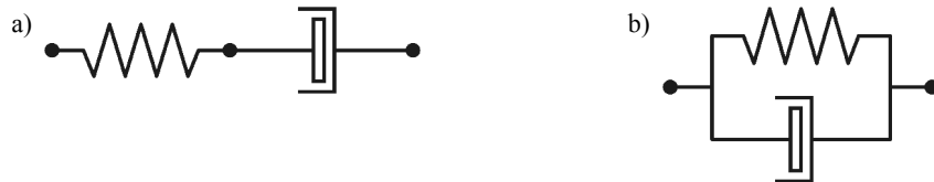
Rys. 4.38. Postać symboliczna modelu lepkościowego według Maxwella (a) oraz Kelvina–Voighta (b)
