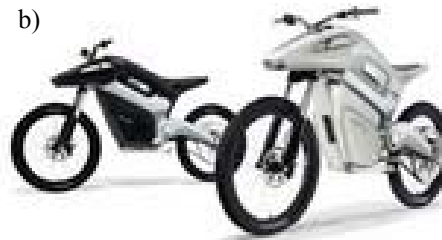
Rys. 6.14. Jednoślady wyposażone w ogniwa paliwowe: a – motocykl Kodescha z roku 1967, b – motocykle z produkcji seryjnej firmy ENV
