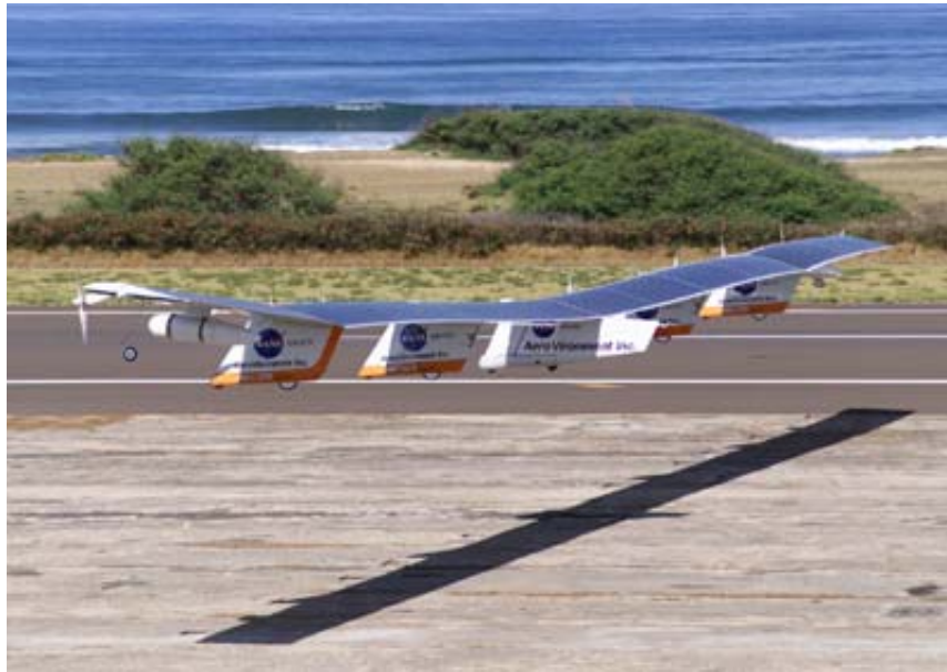
Rys. 5.26. Bezzałogowy samolot zwiadowczo-szpiegowski Helios napędzany ogniwem URFC oraz fotowoltaicznym [5.21]
