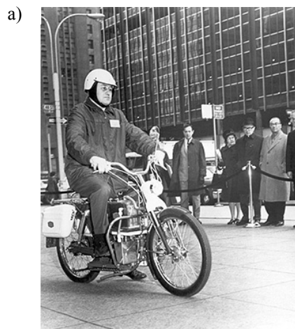
Rys. 6.14. Jednoślady wyposażone w ogniwa paliwowe: a – motocykl Kodescha z roku 1967, b – motocykle z produkcji seryjnej firmy ENV
