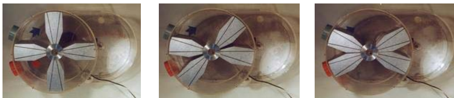
Rys. 6.4. Model silnika X Woźniaka w różnych fazach pracy [6.4]
