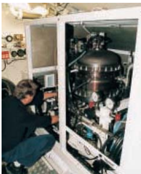
Rys. 6.8. Silnik Sterlinga z łodzi podwodnej Gotland [6.18]
