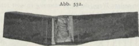
Abb. 552. Rechteckiger Stahlstab, der nach erfolgter Härtung einer Fallgewichtsprobe unterzogen wurde. Das harte, körnige Gefüge an den Oberflächen und das sehnige Gefüge des Innern sind deutlich erkennbar.
