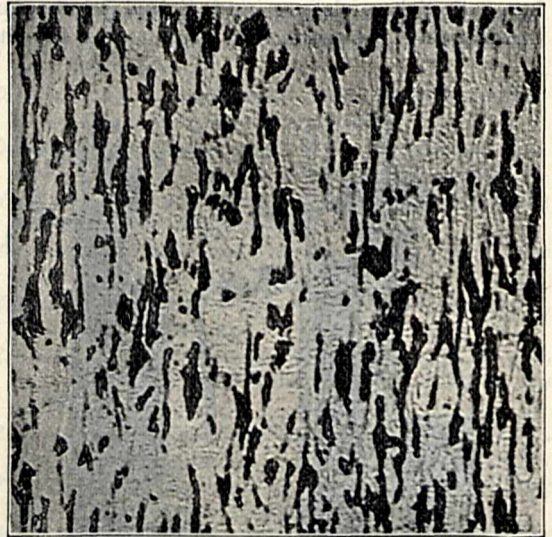
Gefügebild dieses Elektrostahtes nach viermaligem Ziehen.
