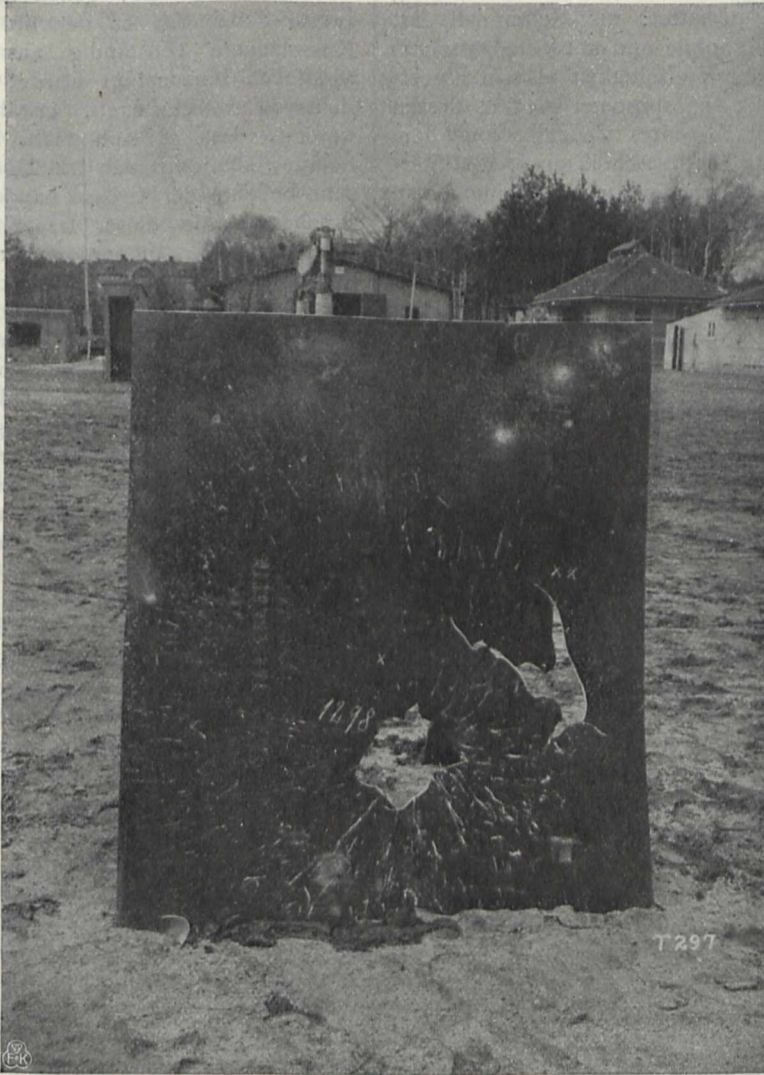
Schildblech, getroffen von einem Granatteil eines 75 mm-Granatschrapnells auf 550 m.
