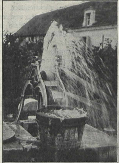
Die Kettenpumpe ohne Pumpengehäuse
