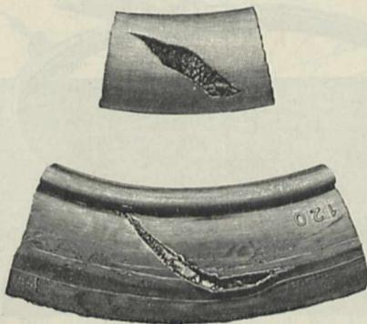
Schwere Verletzung einer Pneumelasticum-Füllung (oben) und der zugehörigen Decke (unten). Nach Eintritt dieser Beschädigung lief die Bereifung noch ungefähr 300 km.
