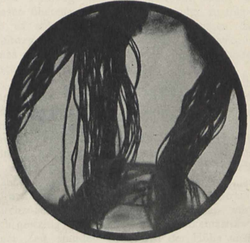
Degea-Kunstseide-Glühkörper nach 250 Brennstunden.
