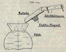
Schematische Darstellung einer Magnet-Anordnung.
