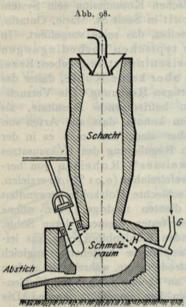
Der 1909 konstruierte schwedische Elektrohochofen (senkrechter Schnitt).
