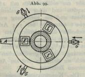
Teil der Elek- Wagerechter Schnitt durch den schwedischen Elektrohochofen. A = Abstich, E = Elektroden.G = Gichtgasleitungen.
