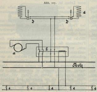
Schaltungsschema einer elektromagnetischen Ausrückvorrichtung.
