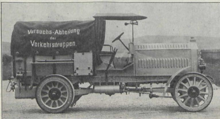
Vorspannmaschine mit Vierräderantrieb der Daimler-Motoren-Gesellschaft.
