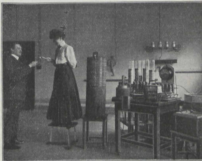
Wirkung des elektrischen Feldes einer Resonanzspule.
