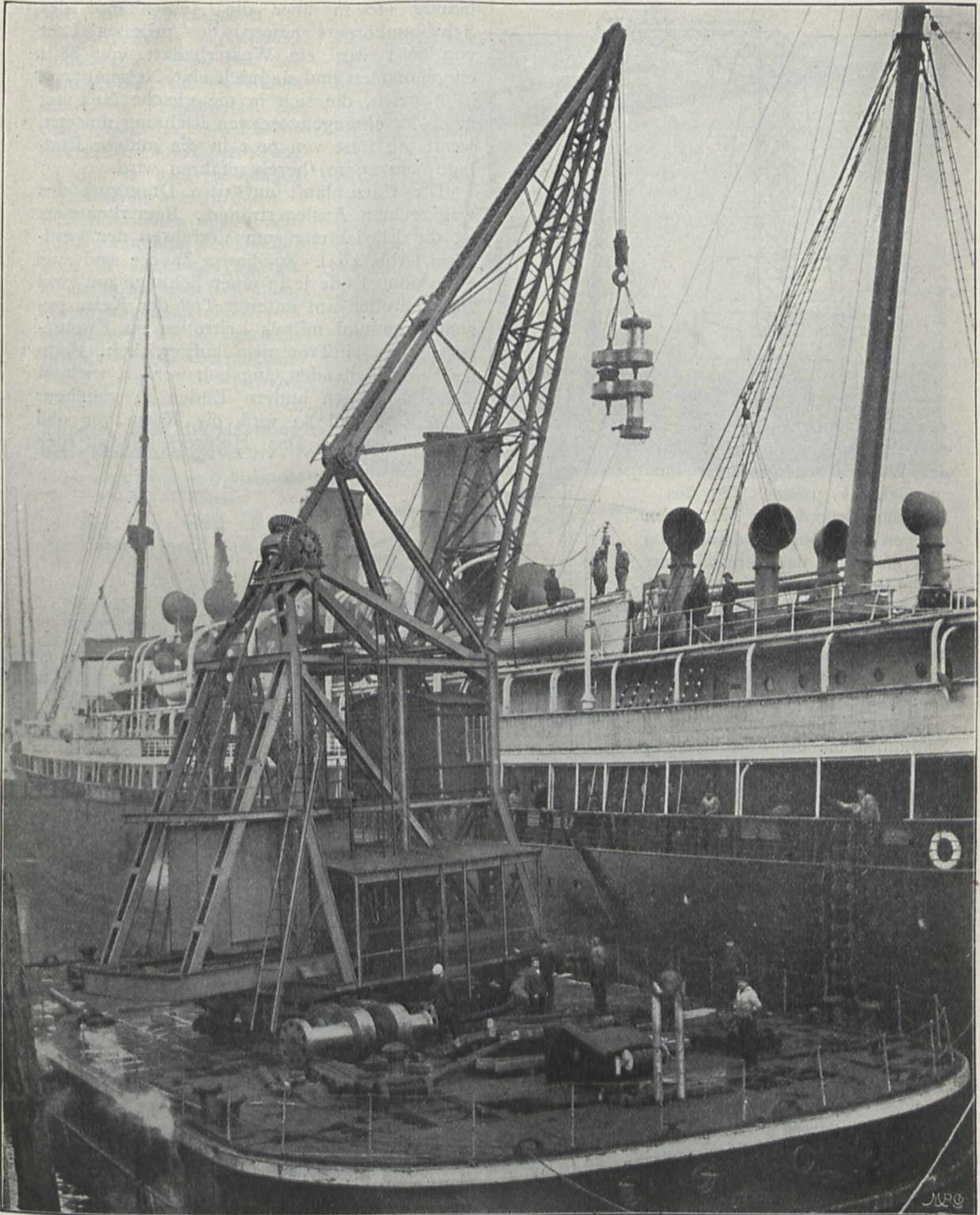
30 t-Schwimmkran für Schiffsmontage und Verladezwecke für die Hamburg-Amerika-Linie, ausgeführt von der Duisburger Maschinenbau-A.-G. vorm. Bechem & Keetman in Duisburg.
