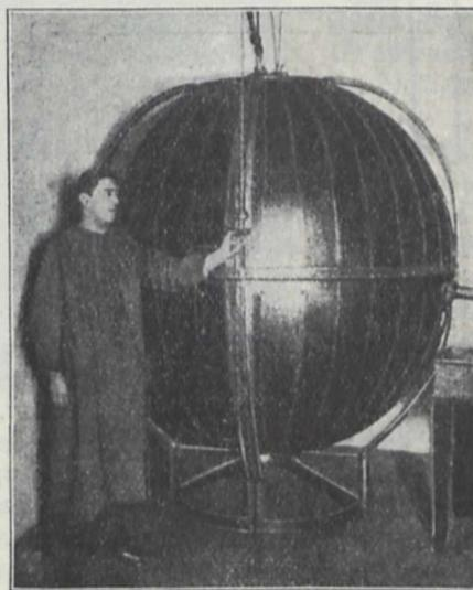
Ulbrichtsche Kugel aus Blech von 2 m Durchmesser.
