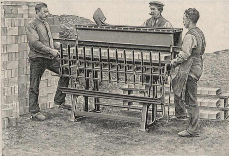
Cementmauerstein-Formmaschine „Pionier“ für gleichzeitige Anfertigung von je 12 Steinen, gebaut von der Leipziger Cementindustrie, Dr. Gaspary & Co., Markranstädt bei Leipzig.
