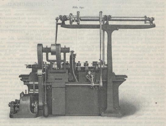
Nortons Schleifmaschine mit Riemenantrieb; Rückansicht.
