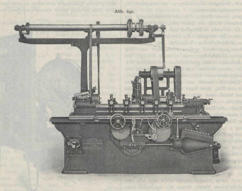
Nortons Schleifmaschine mit Riemenantrieb; Vorderansicht.
