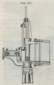
Aeltere Ausführung des Motorkörpers für Pumpenbetrieb.
