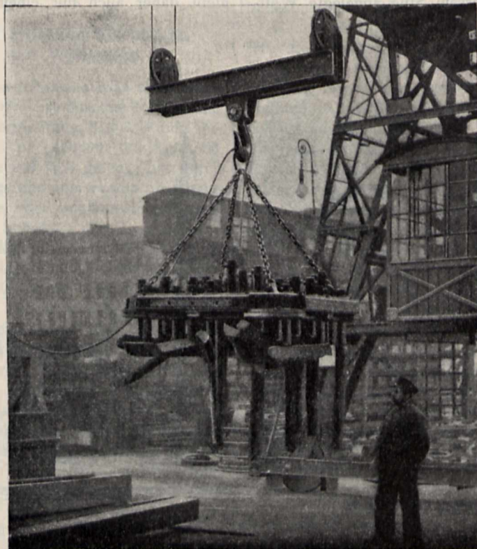
Abb. 426. Magnet, rechteckig mit beweglichen Polen, zum Heben von Körpern mit unebener Oberfläche.
