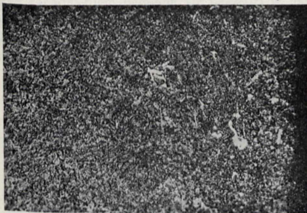
Rys. 16. Próbkę stali A (0,17% C) nawęglaną 12 godz. w temperaturze 930 o , wyżarzona w temperaturze 680 o w ciągu 2 godz. oraz hartowana w oleju w temperaturze 850 o i 840 o . Brzeg nawęglony.
