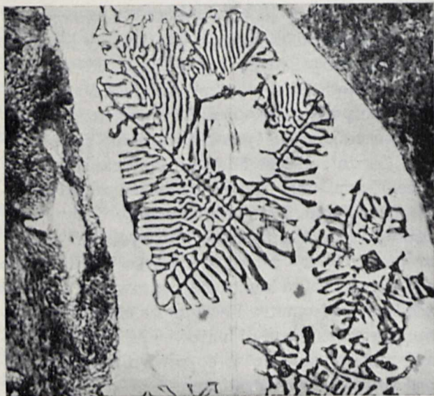
Rys. 7. Pola ledeburytyczne w strefie nadtopienia płytki i trzonka, wykonanego z miękkiej stali węglowej, przy elektrycznym zgrzewaniu oporowym. Po 1000 \times \emptyset . Trawienie kombinowane: Murakami i kwas azotowy.
