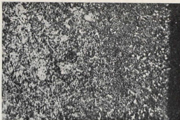
Rys. 15. Próbkę stali A (0,17% C) nawęglaną 6 godz. w temperaturze 930°, wyżarzona w temperaturze 680° w ciągu 2 godzin oraz hartowana w temperaturze 840° w oleju. Brzeg nawęglony. \times 250 .
