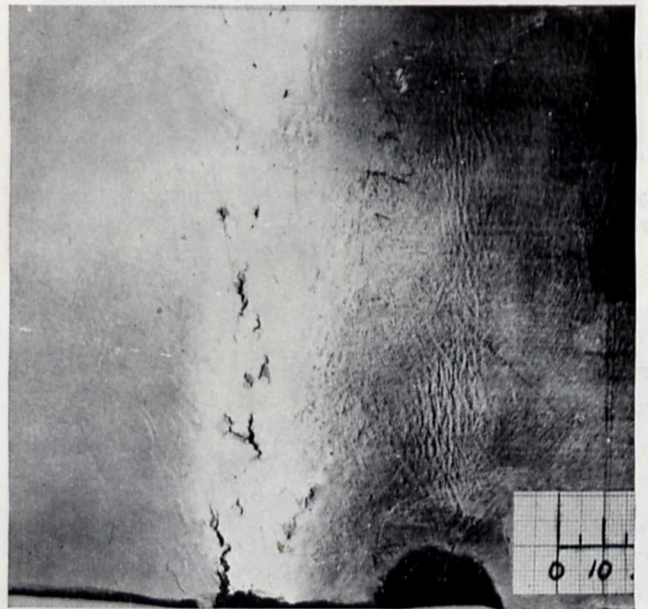
Rys. 11. (2/3 n. w.). Płytką giętą z rysami, pobrana wzdłuż z górnej połowy surowego wlewka stali chromowo-niklowej wadliwej.
