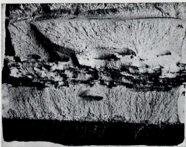
Rys. 21. (n. w.). Przełom wycinka płyty walcowanej ze stali Ni-Cr. Szczeliny, jako odpowiedniki płatków.
