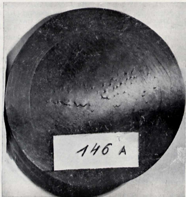
Rys. 9. (n. w.). Rysy na giętej płytce stali wadliwie walcowanej, jak stal rys. 10.
