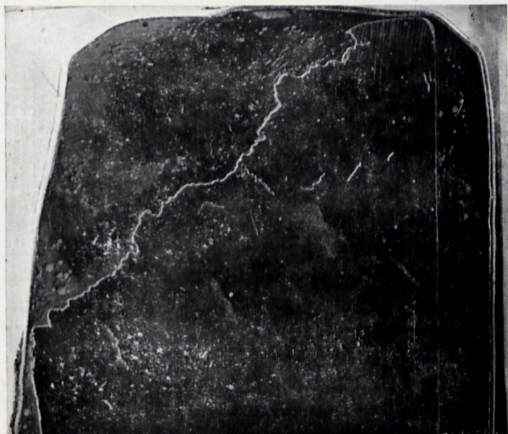
Rys. 2. ( \times 2 ). Zgląd wycięty poziomo z okazu rys. 1. Oświetlenie specjalne dla dokładniejszego uwidocznienia włoskowatych pęknięć oraz zanieczyszczeń stali; zgląd nietrawiony.
