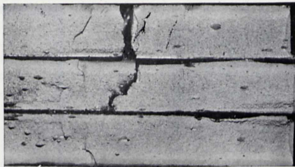
Rys. 23. (1,5 n. w.). Przełom poprzeczny blachy rys. 22. Szczeliny w miejscu płatków.
