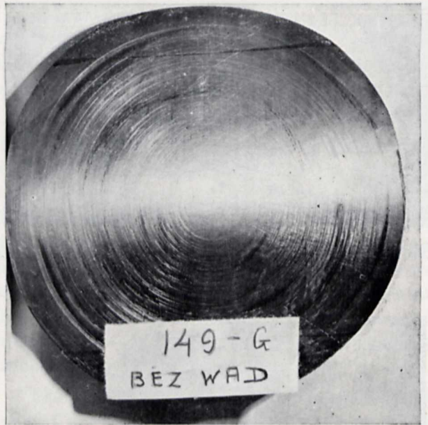
Rys. 10. (n. w.). Płytką giętą z kęsa zdrowej stali walcowanej w tych samych warunkach, co stal rys. 9.
