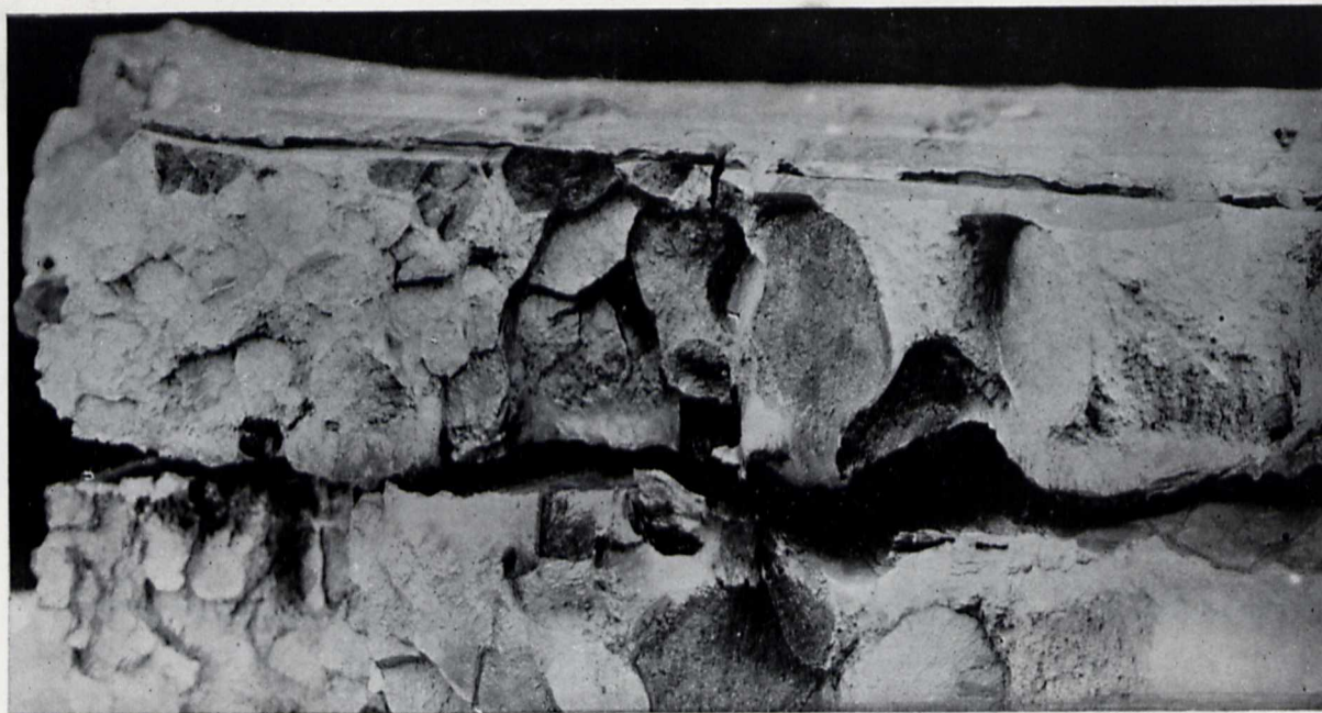
Rys. 20. (n. w.) Stal Ni-Cr kuta z wlewka 1200 kg na 400 \times 200 mm. Na przełomie płyty wielkie płatki.
