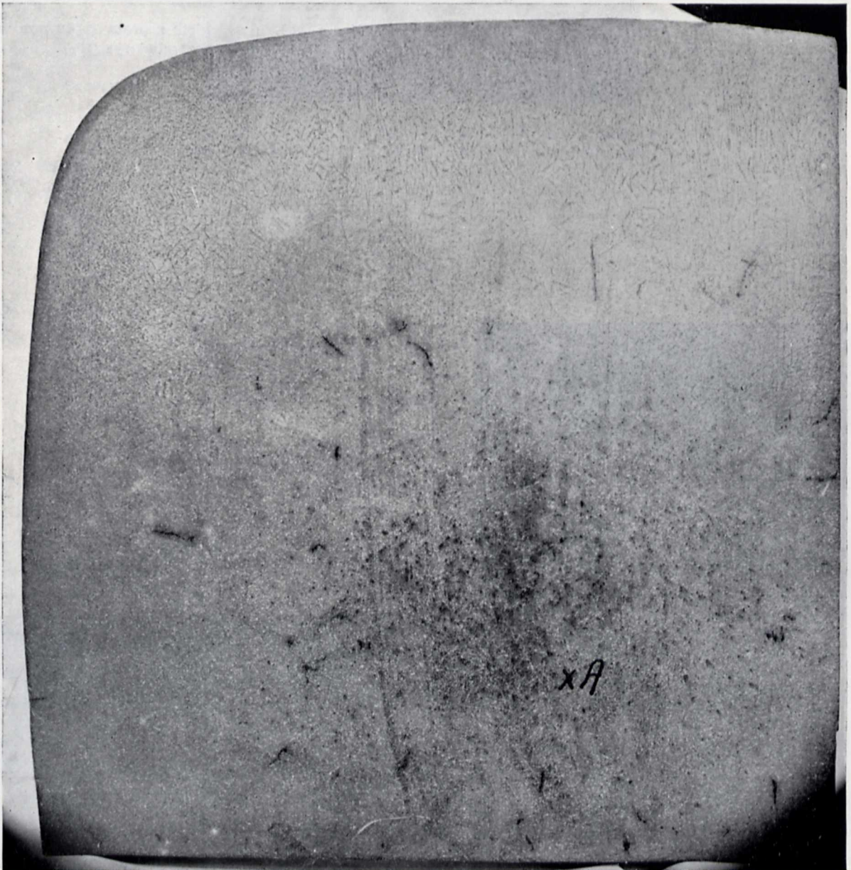
Rys. 13. (2/3 n. w.). Płyta wadliwej stali z surowego wlewka top nr. 139. Rysy i pęknięcia oraz zanieczyszczenia ułożone centrycznie około środka „A”. Wytrawiono odczynnikiem Oberhoffer'a.
