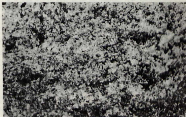
Rys. 3. „a” — przełom bardzo złego odlewu, „b” — przełom nieco lepszego odlewu i „c” — przełom znośnego odlewu. Pow. 5 \times \varnothing .
