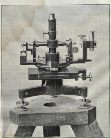
Die Basismessungen: Ablothung mit centrischem Fernrohr.
