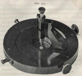
Die Basismessungen: Centrirungsapparat mit eingesetztem Markirstift.
