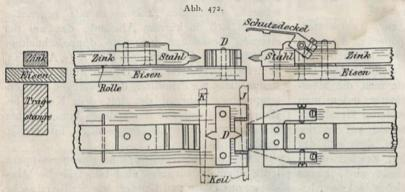
Die Basismessungen: Bessels bimetallische Messstange.
