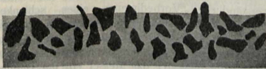
Schematische Darstellung der Oberfläche eines Abziehlsteines. (Ausserordentlich stark vergrössert.)
