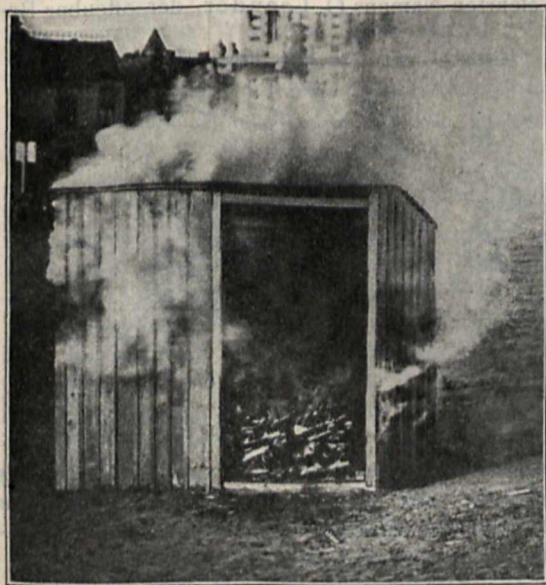
Versuch mit unverbrennlichem Holz: Die Versuchshütten nach einer Brenndauer von 20 Minuten.
