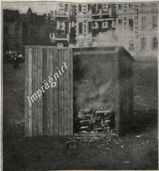
Versuch mit unverbrennlichem Holz: Die Versuchshütten im Moment der Anzündung.
