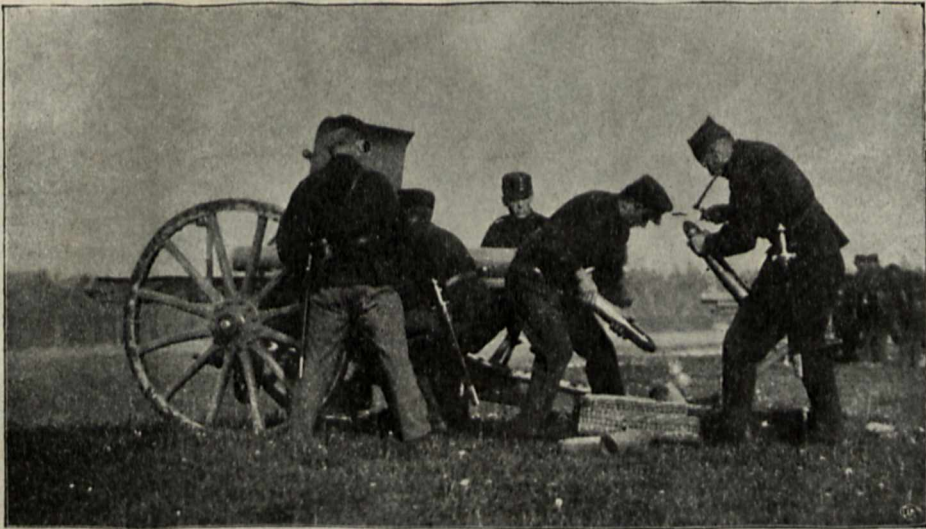
Kruppsches 7,5 cm-Feldgeschütz mit Rohrrücklauf bei den Schiessversuchen in der Schweiz. Geschütz beim Schuss.
