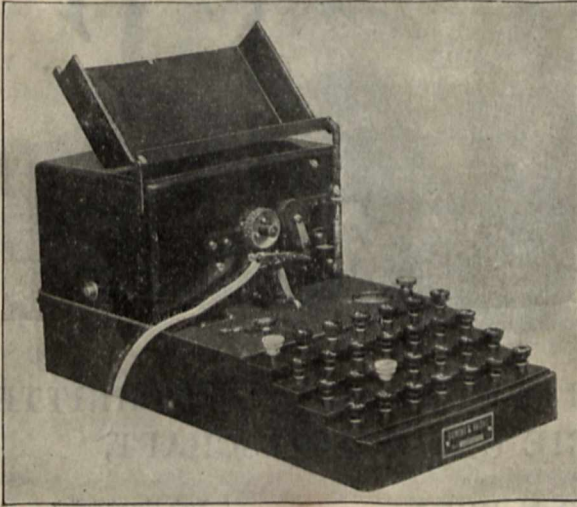
Elektrischer Ferndrucker mit Motorantrieb, im Schutzkasten.
