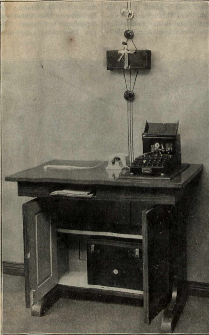
Der elektrische Ferndrucker: Teilnehmerstation.
