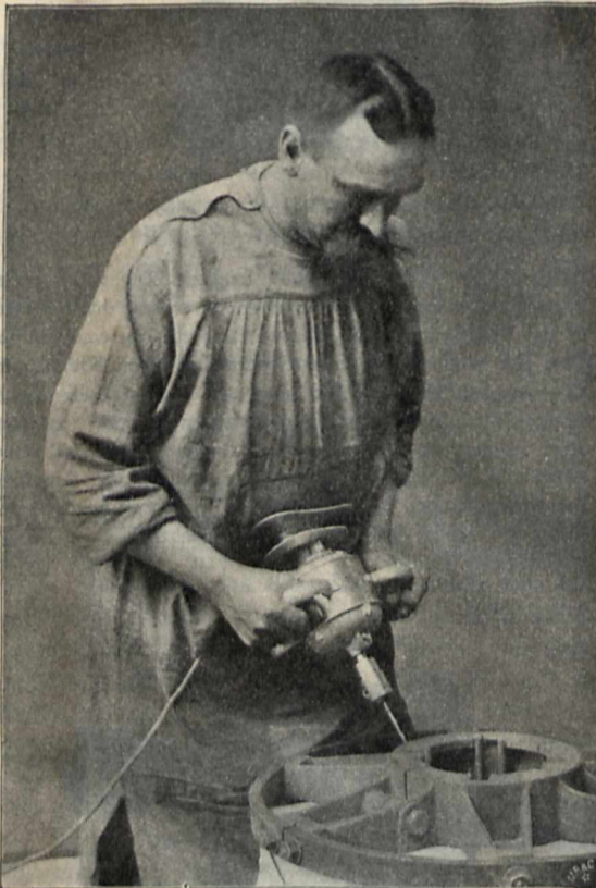
Die elektrische Handbohrmaschine von Siemens & Halske A.-G. in Berlin in ihrer Anwendung.
